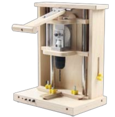
使用钻孔机时需要双手相互协调并灵活操作：一只手转动钻孔机后侧的圆盘曲柄，另一只手将钻孔机前方的手柄向下按压。
